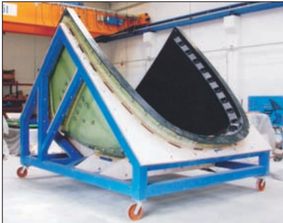
GFK-Negativform, Kopfmodul eines Nahverkehrsuges
