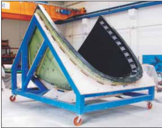
GFK-Negativform, Kopfmodul eines Nahverkehrsuges
